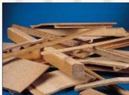
Tech-Wood is een combinatie van houtvezels en kunststof.
